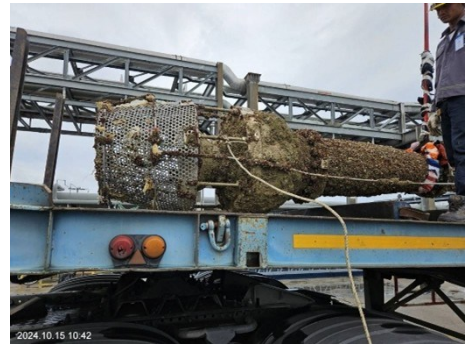
ภาพที่ 2.2-22 ตะแกรงกรองขนาด 16 มิลลิเมตร ที่หัวเครื่องสูบน้ำทะเล
