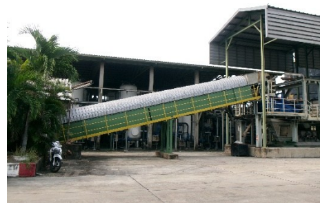
ภาพที่ 2.2-10 อุปกรณ์ปิดครอบสายพานลำเลียง อย่างมิดชิด
